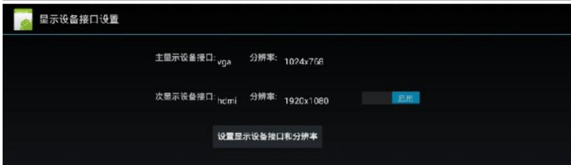
图 4.5 显示设备接口和分辨率设置
