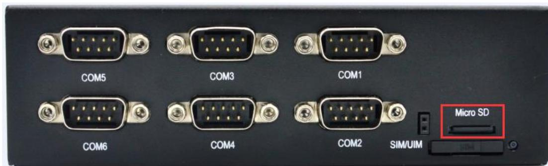
图 3.10 Micro SD 卡槽
