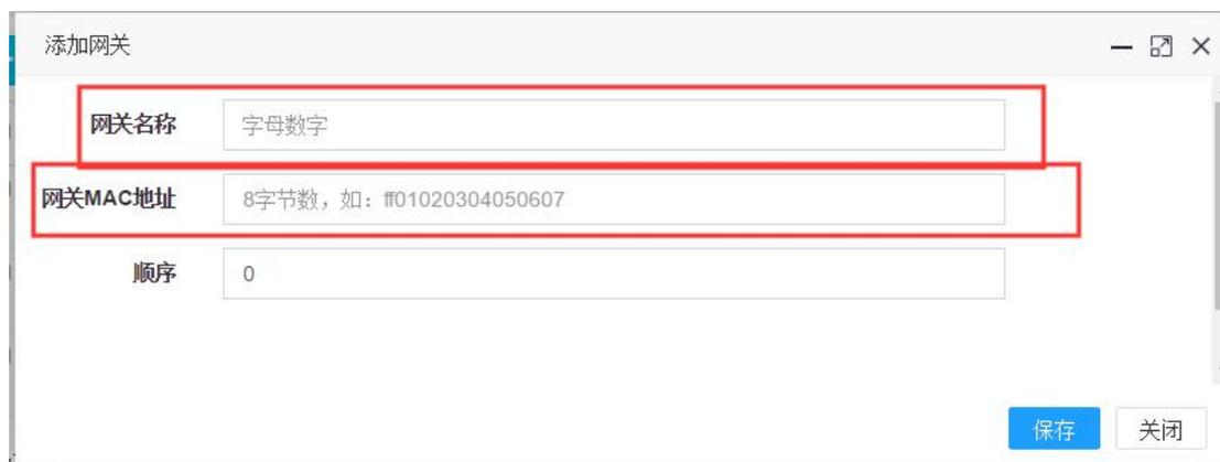
在弹出的添加框中输入网关名称及网关的 MAC 地址，请确保网关 MAC 地址输入正确。
