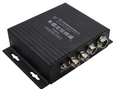
F-V111 V2 系列是工业级车载终端,采用高性能工业级 32 位处理器,内置高精度 RTK 板卡;通过 3G/4G/5G 与千寻平台建立通道,把 GGA 信息发给差分服务器,同时接收差分信息后,再通过 RS232/CAN(可选)输出精准位置信息。
