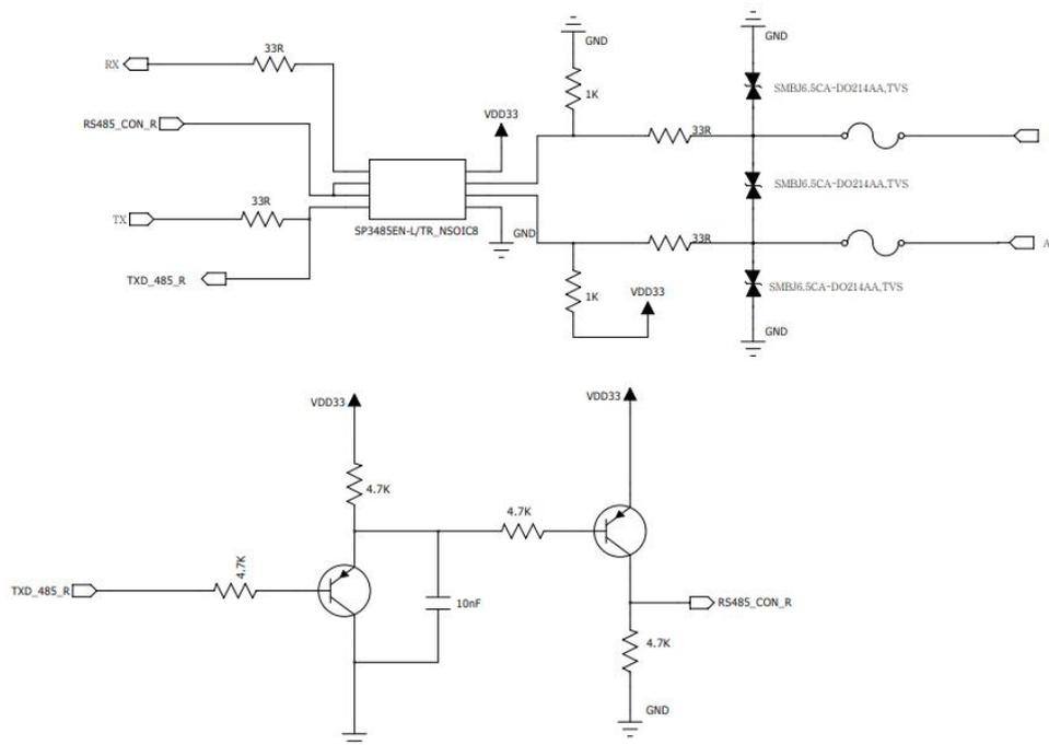
图 3-2 F8L10A-N/F8L10A-E 与工控机 RS485 连接的参考电路
