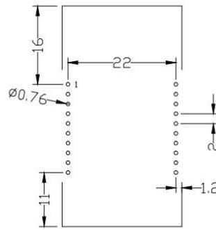
图 4-7 F8L10A-E 插装焊盘尺寸
