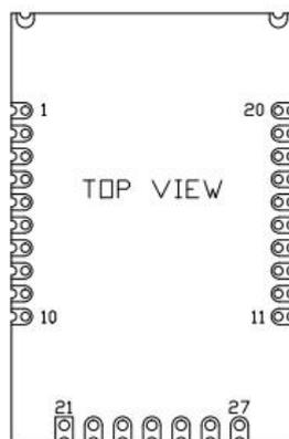
图 2-1 模块引脚图 F8L10A-N/F8L10A-E
