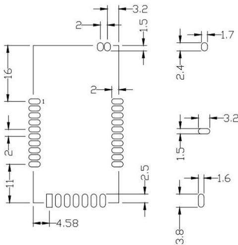
图 4-6 F8L10A-E SMT 焊盘尺寸
