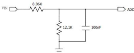
图 3-5 最大 5V 电压采集方式
