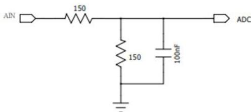
图 3-6 最大 20mA 电流采集方式
