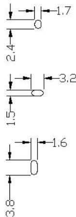
图 4-4 F8L10A-N 插装焊盘尺寸
