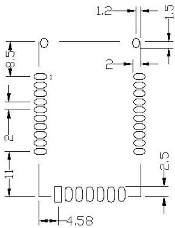
图 4-3 F8L10A-N SMT 焊盘尺寸
