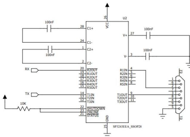
图 3-1 F8L10A-N/F8L10A-E 与 PC RS232 连接的参考电路
