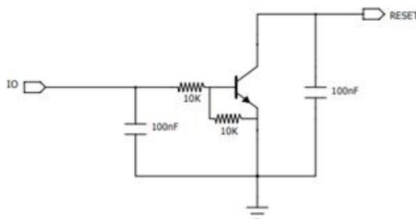
图 3-3 MCU 控制三极管复位参考电路
