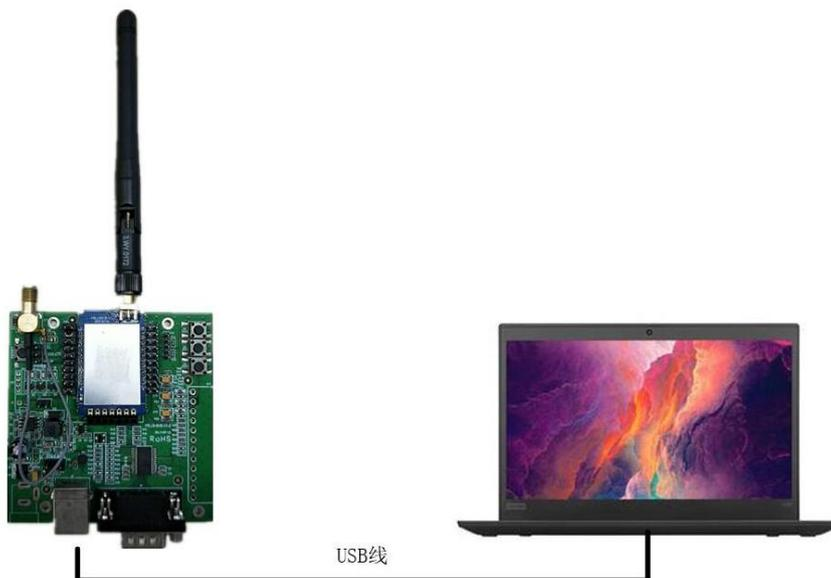
图 4-1 F8L10A 系列与 PC 的配置连接
