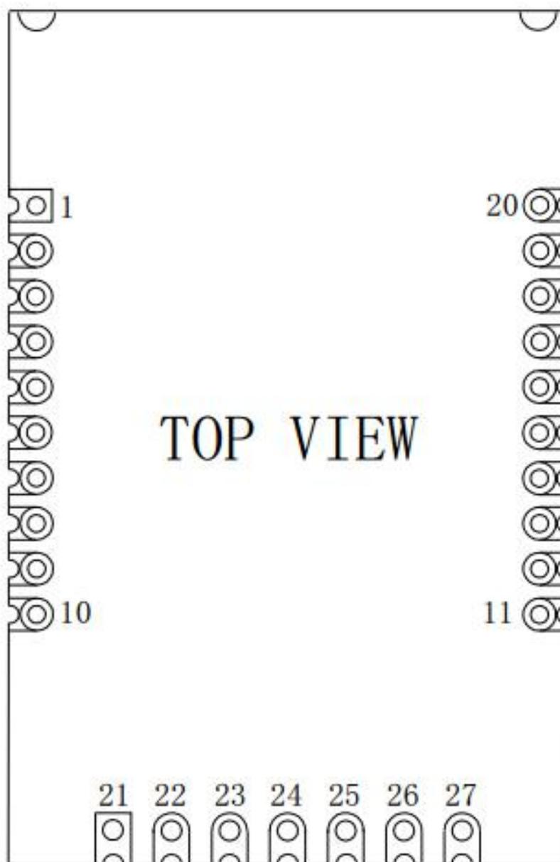
图 2-1 模块引脚图 F8L10A-N 和 F8L10A-E
